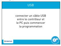
Lorsque l'écran USB apparaît, brancher un câble USB sur le port USB de la carte électronique du contrôleur (voir 5.8. Raccordements (électriques), page 45 pour l'emplacement du port USB). Connecter l'autre extrémité du câble USB à un PC avec le logiciel Field Programmer installé et suivre les instructions du manuel XTR Field Programmer pour réaliser la connexion.
