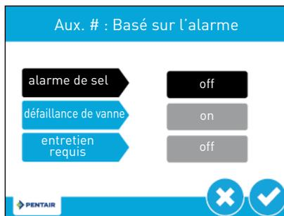
**alarme de sel** : Peut être réglé uniquement si un capteur de sensibilité est installé.
