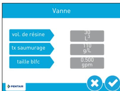
**vol. de résine** : Permet de régler le volume de résine d'adoucissement de l'eau.
