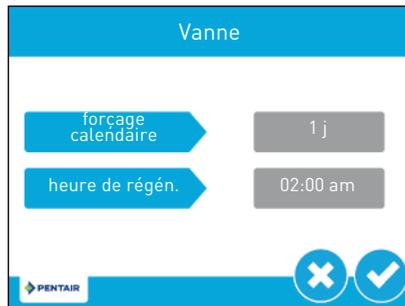
**forçage calendaire** : Permet de régler la durée entre régénérations si le volume de résine n'est pas atteint.
