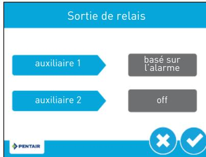
**auxiliaire 1 / auxiliaire 2** : Contient les paramètres pour la programmation d'au maximum deux sorties de relais auxiliaires. Il y a quatre types de signaux programmables :
